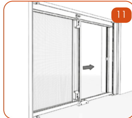
Far avanzare la prima barra maniglia tenendola perpendicolare al pavimento.
